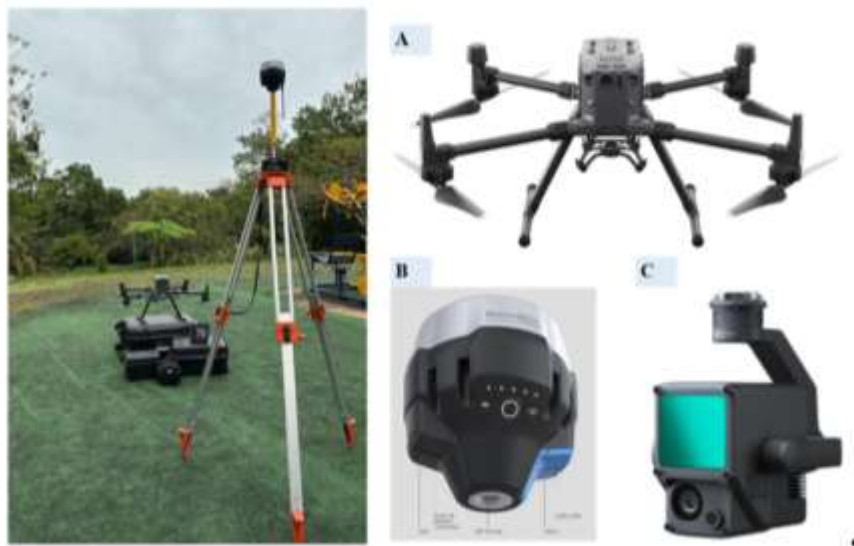
Figura 2. VANT (Veículo Aéreo não Tripulado). A) DJI Matrice 300 RTK (DJI, 2022), B) GNSS de precisão Emlid Reach (EMLID, [s.d.]), Câmera Zenmuse L1 com sensor LIDAR e RGB integrados (DJI, [s.d.]).
