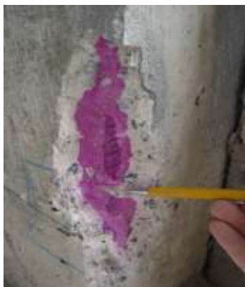
Figura 16. Técnica para avaliar a profundidade de carbonatação.
