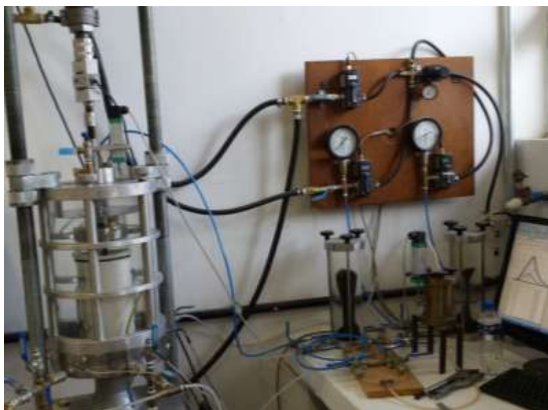
Figura 9. Exemplo equipamento ensaio triaxial.
