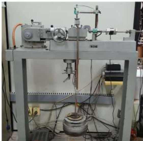
Figura 10. Exemplo equipamento de cisalhamento direto (Esq) e Amostras ensaiadas (Dir).
