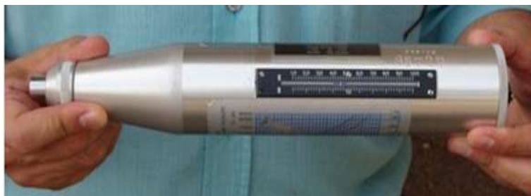
Figura 15. Equipamento usado para avaliar Esclerometria.
